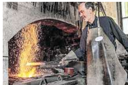
Hannes Köck am Bröcklofen, wo der Sensenstahl glühend und bearbeitbar gemacht wird
