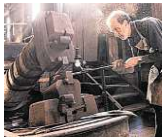
Hannes Köck am Bröcklofen, wo der Sensenstahl glühend und bearbeitbar gemacht wird
